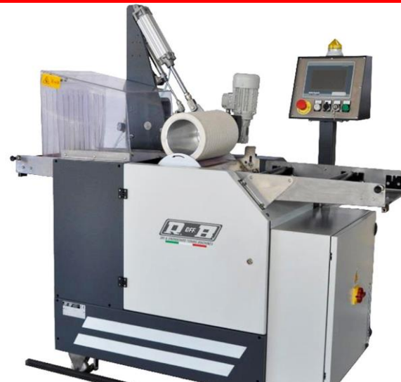
6 NR-35S Шлайфмашина с функциите на NR-35 с добавен реверсивен механизъм за водене
